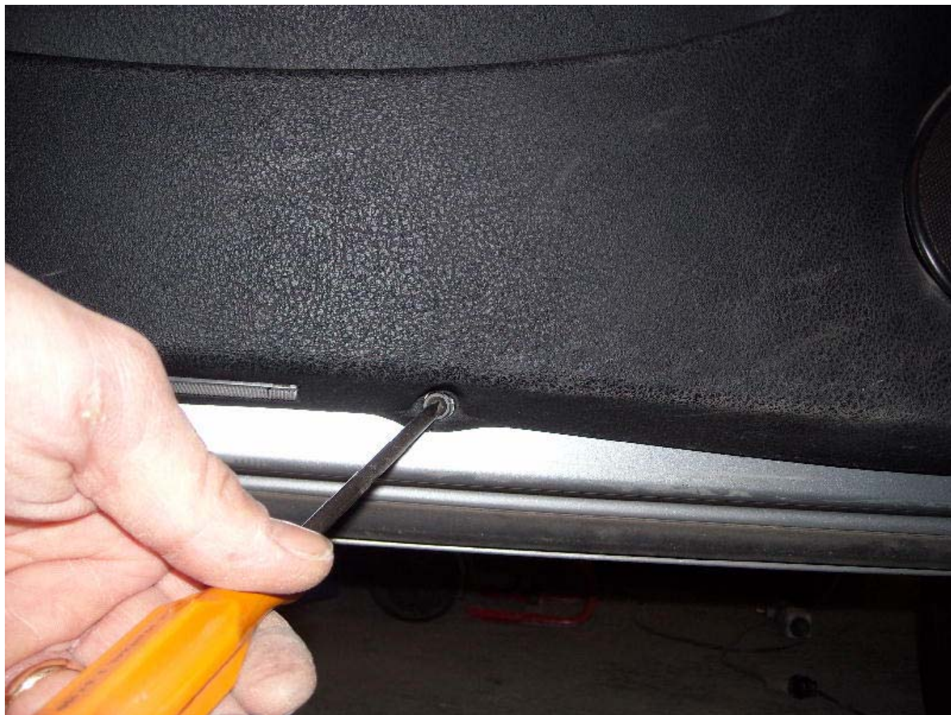
Scalziamo la plastica con un cacciavite
