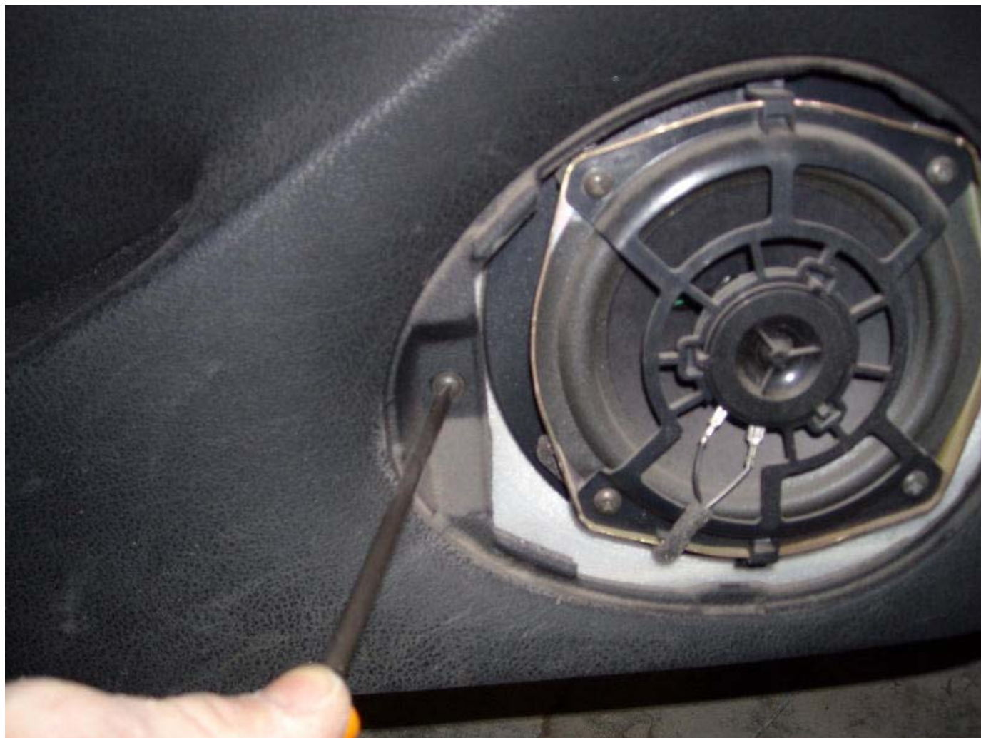
Scalziamo la plastica con un cacciavite
