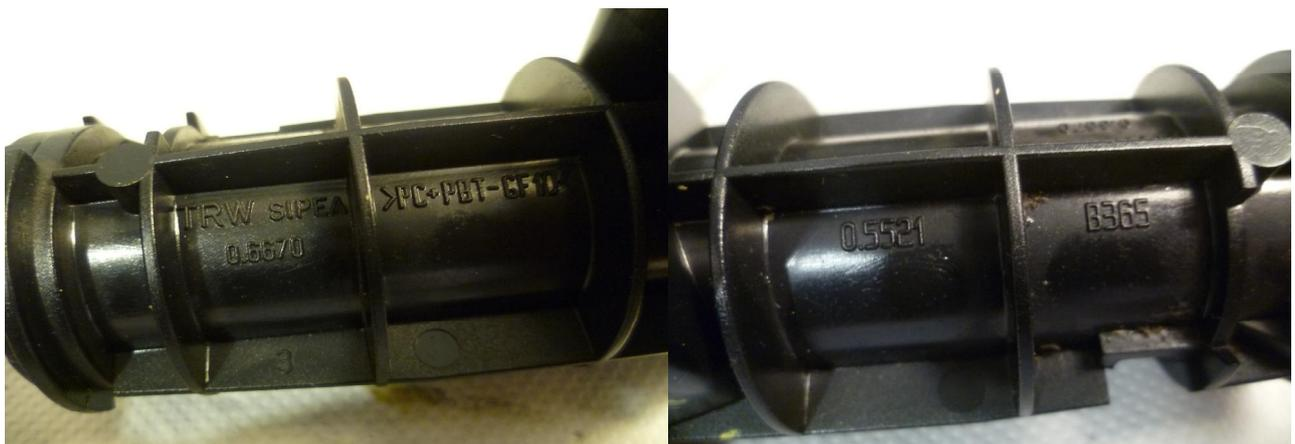
Fig. N : I riferimenti del commutatore completo TRW sipea 0.6670 0.5521
