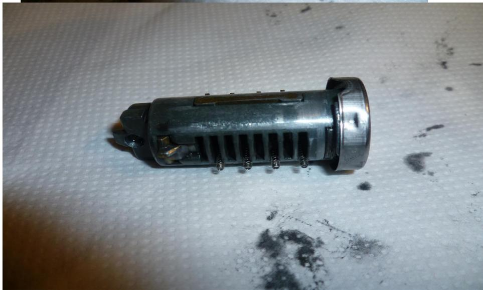
Fig. M : La serratura con le lamelle e senza
