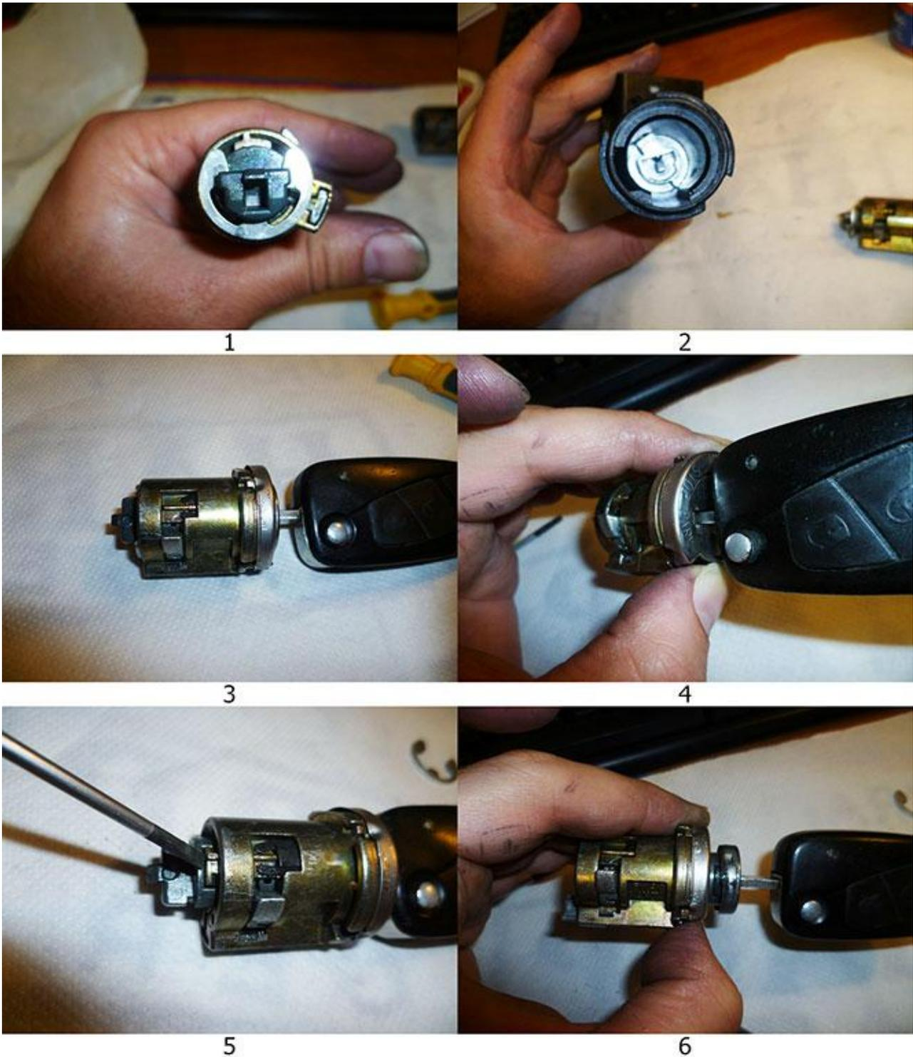
Fig. L : estrazione della serratura dal blocchetto per chiave
