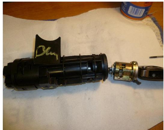
FIG.C-Blocchetto per chiave (a dx) estratto dal commutatore di avviamento completo
