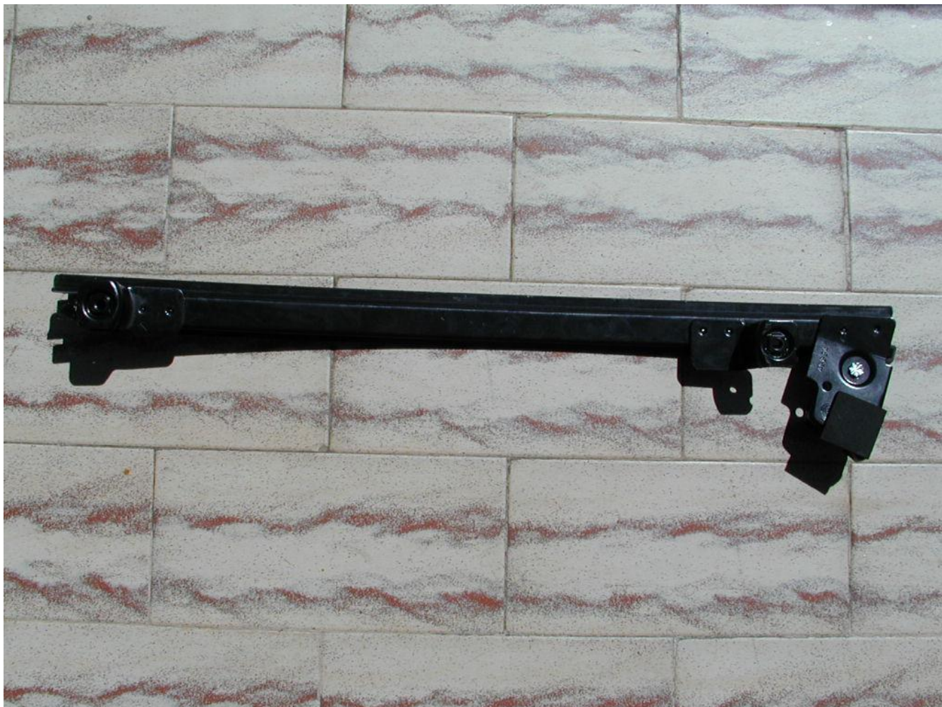
Qualche piccolo affinamento al pattino in modo che scorra liberamente, ma senza gioco, sulla guida: Foto 16-17
