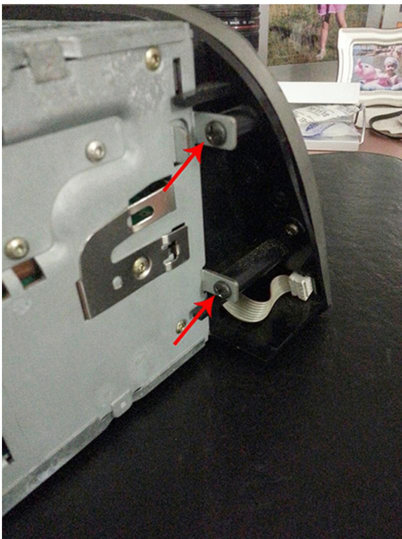
A seguire bisogna scattare i connettori visibili nelle foto seguenti, con particolare attenzione al cavo *flat* per il quale vanno preventivamente allentate le due alette poste a lato del relativo connettore.
