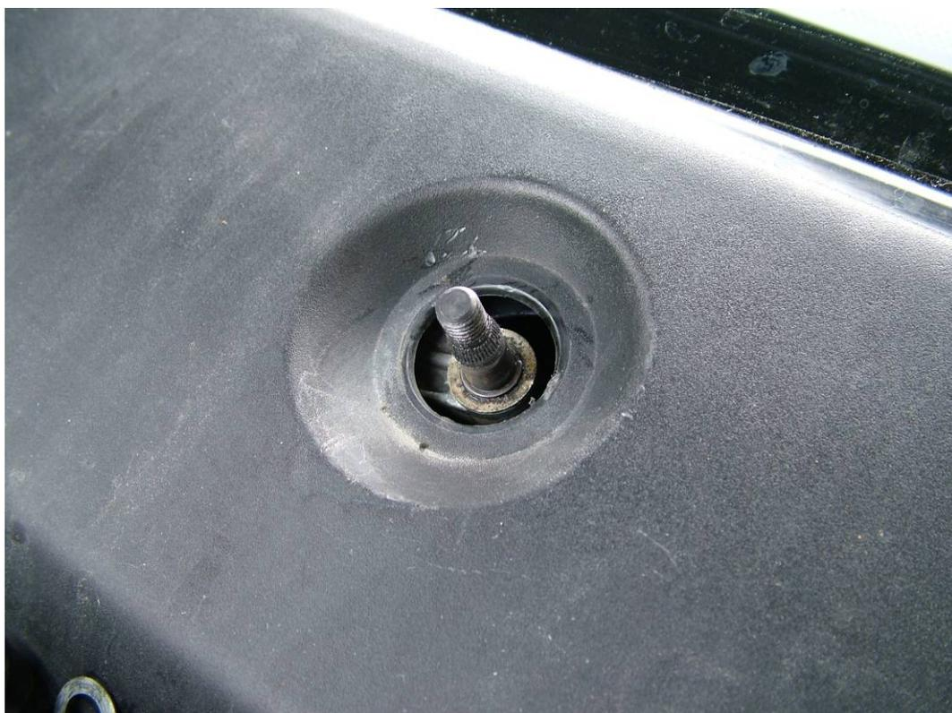
Foto 3 – Vista del perno motorizzato dopo la rimozione del braccio del tergicristallo
