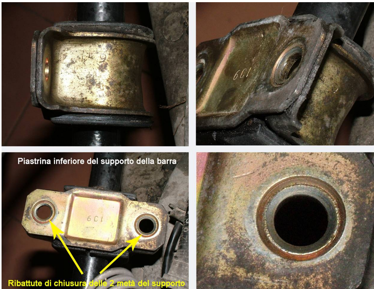
Foto 3 – Unione delle due metà del supporto metallico
