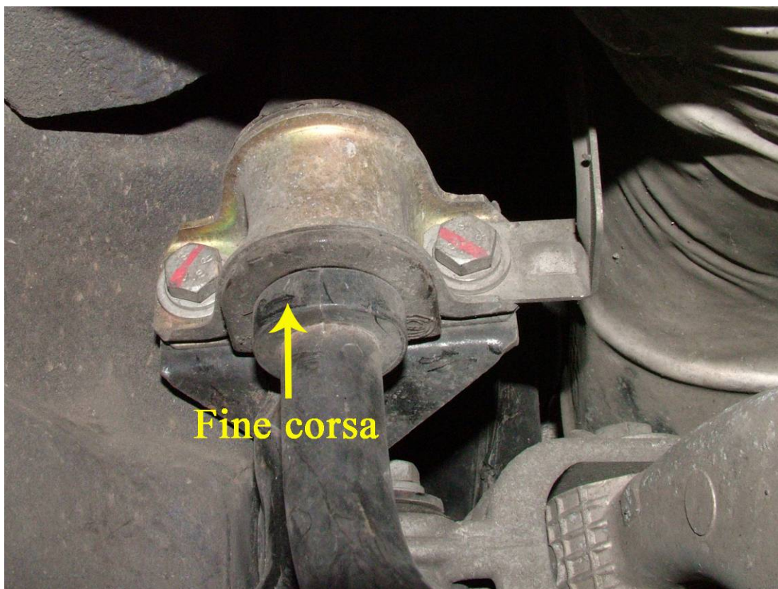
Foto 12 – Fine corsa presente sul lato esterno del supporto sinistro della barra posteriore
