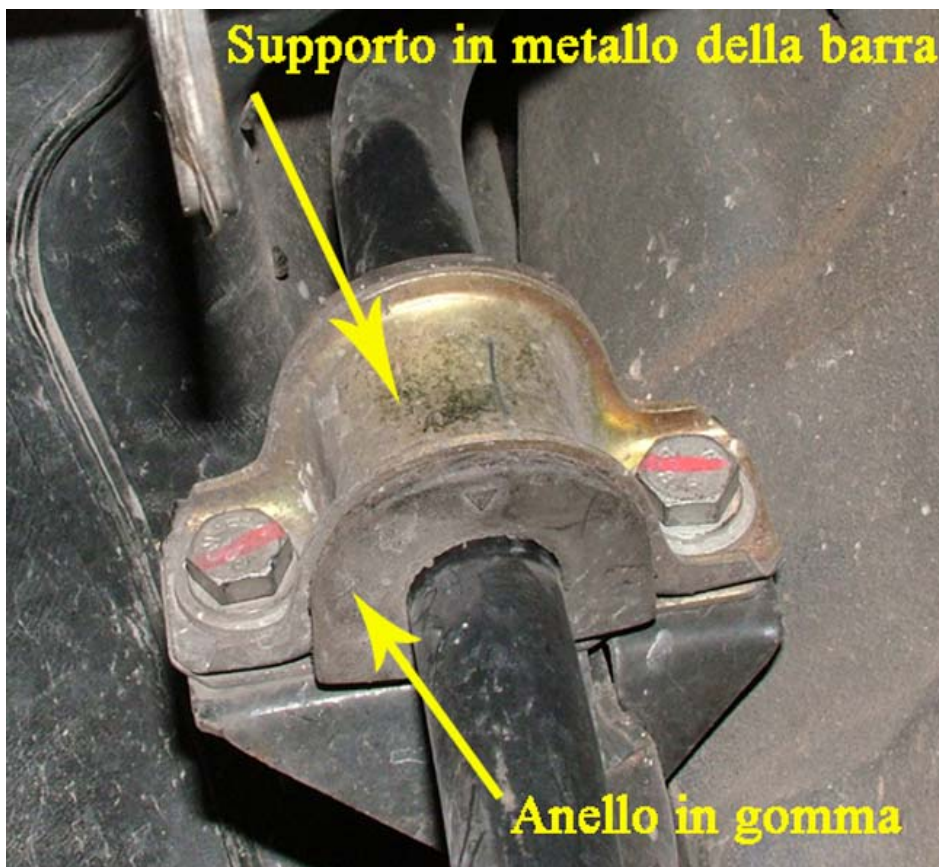
Foto 1 – Supporto della barra di torsione posteriore
