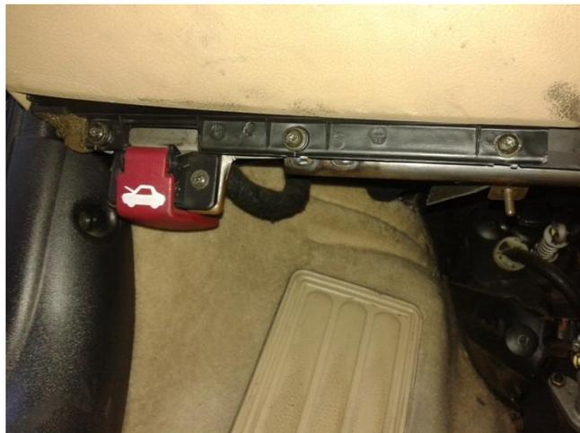
Poi occorre smontare il guscio del piantone : ci sono tre viti a stella accessibili da sotto , due vicino al volante ed una al centro vicino alla leva della regolazione ;
