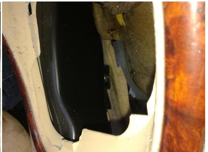
A questo punto , potete fissare la centralina clima con la vite centrale in alto al posto della vite centrale del cruscotto tolta in precedenza.
