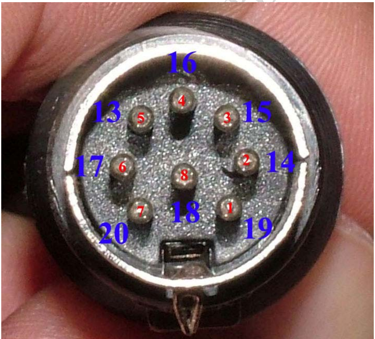
Foto 5 – Corrispondenza dei pin della giunzione “maschio” D96 (rosso) con quelli del connettore P20E (blu)
