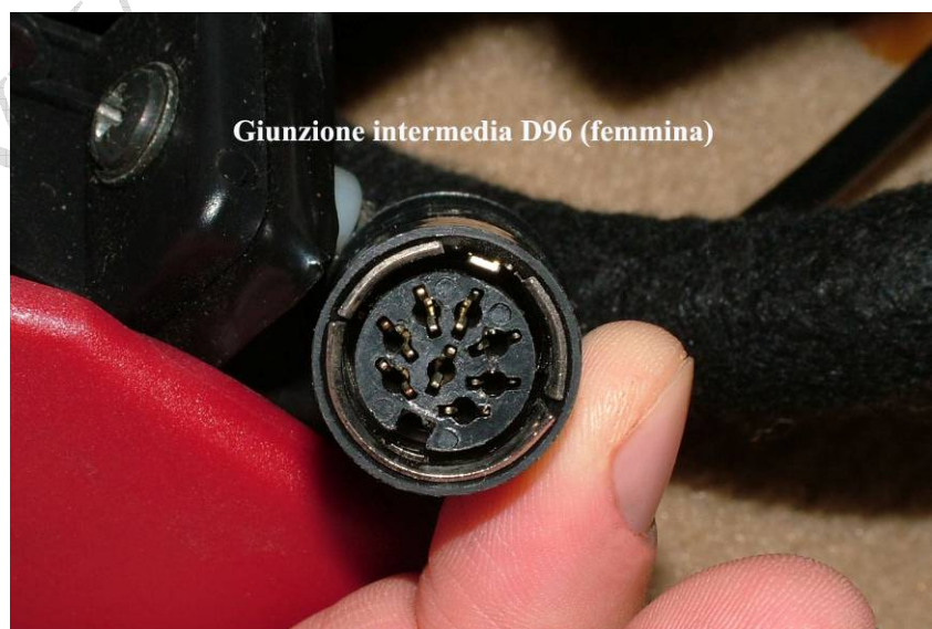
Foto 3 – Connettore femmina presente all'estremità del cavo proveniente dal caricatore CD
