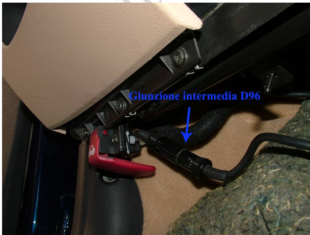
Foto 1 – Localizzazione della giunzione intermedia D96 cambia CD
