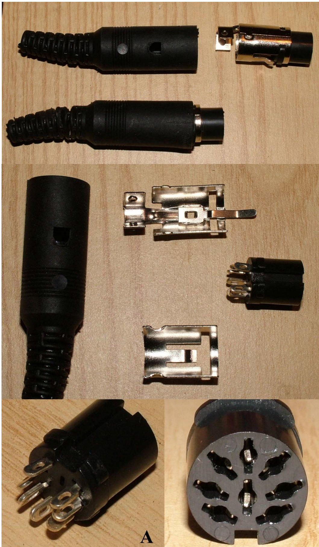
Foto 7 – Connettore DIN 8 pin femmina, volante : parti costituenti
