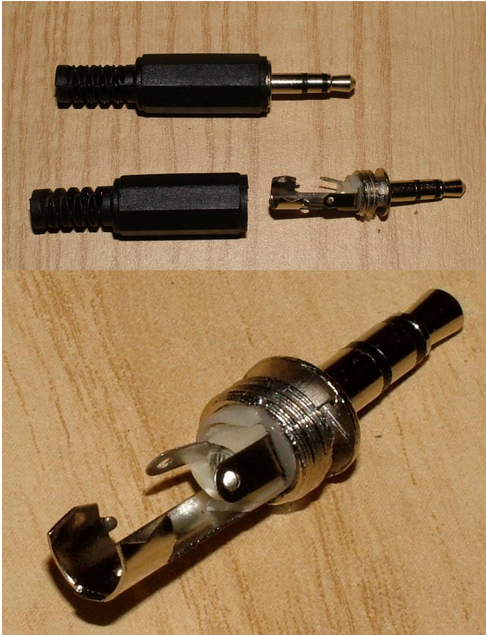
Foto 8 – Jack maschio da 3,5, volante : parti costituenti (la parte metallica è avvitata sul corpo in plastica)
