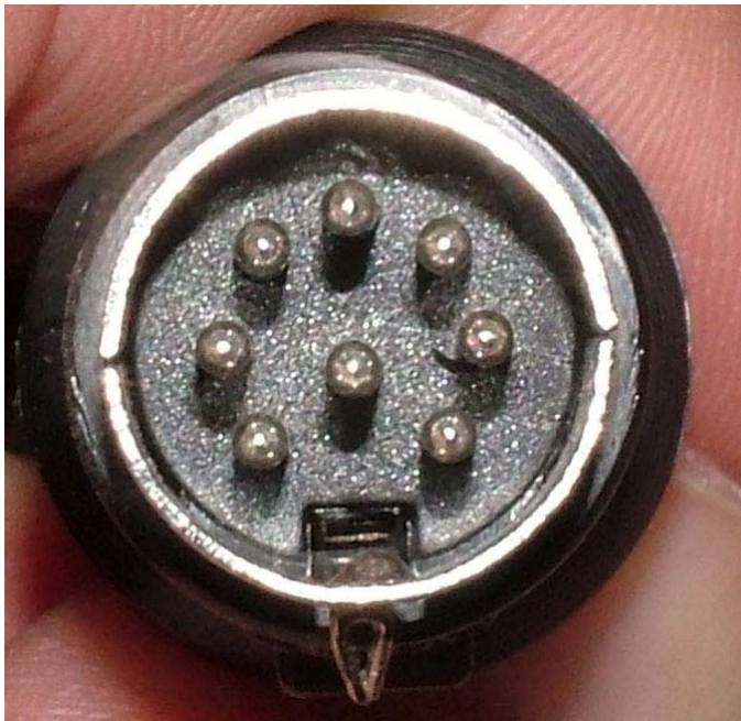
Foto 4 – Localizzazione dei pin sul connettore maschio proveniente dall'ICS
